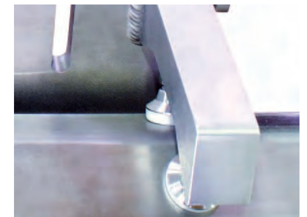
Minimierte Flächen zwischen Baugruppen /// Minimised surfaces between components
