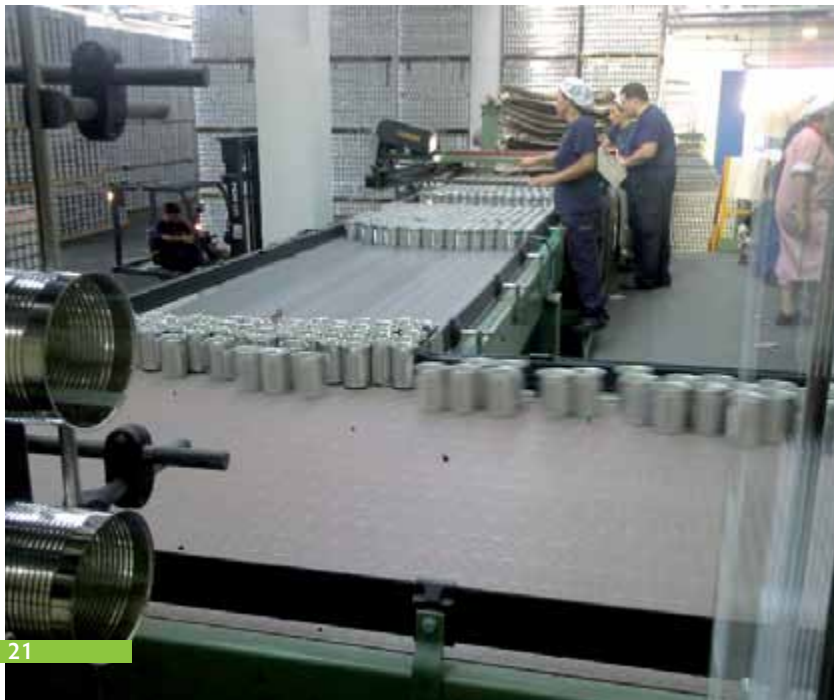
21 Sistema automatico di smistamento e trasporto barattoli, ad alta capacità Automatic system for handling and sorting for cans, high capacity
