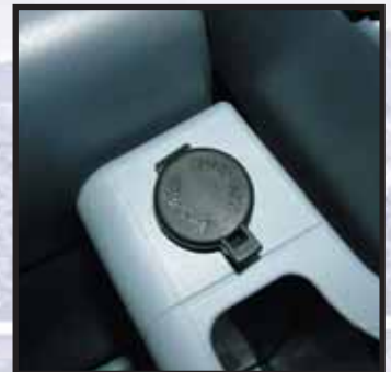
12 Volt power supply
